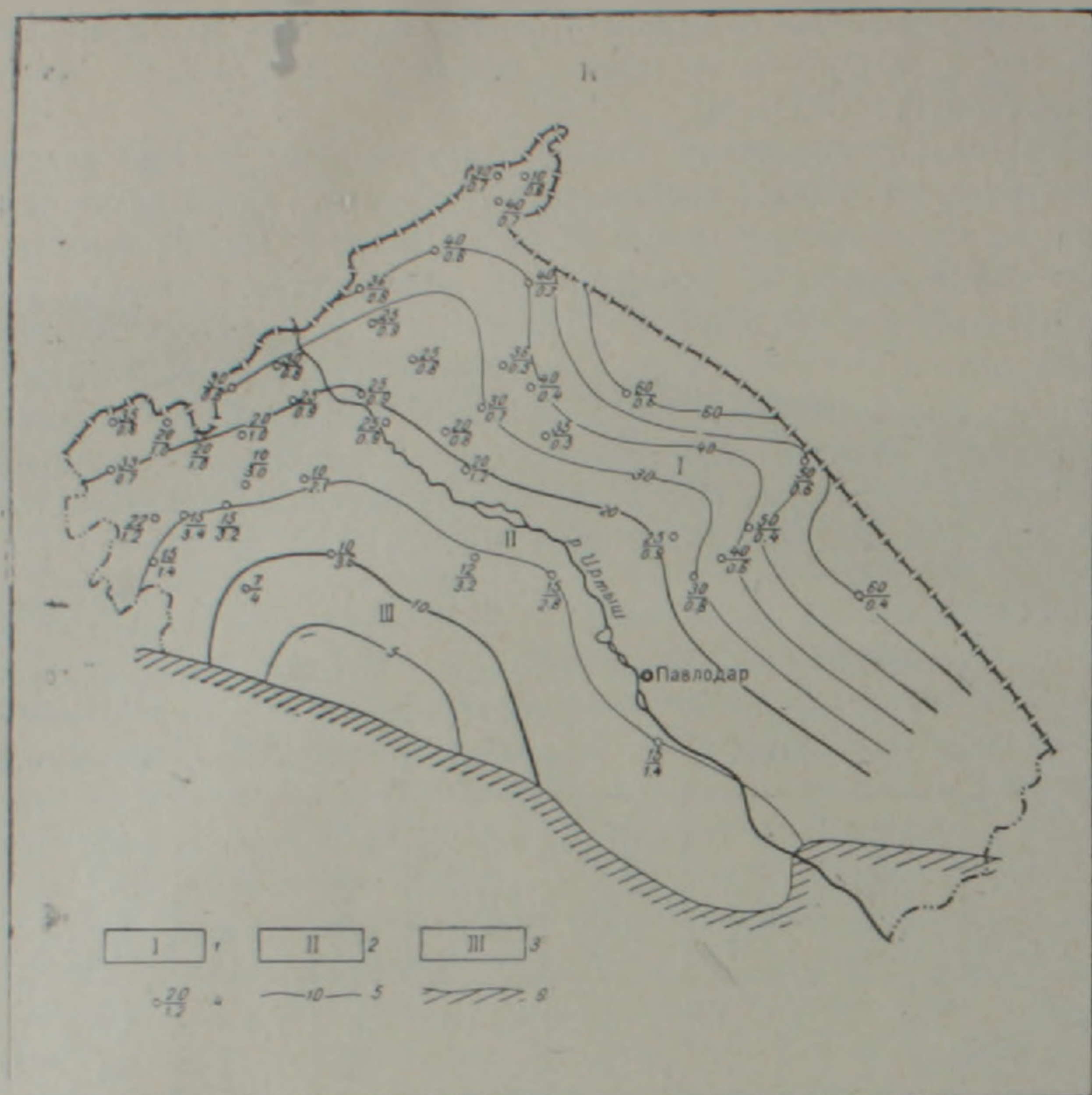
Фиг. 1. Карта общей минерализации покурского водоносного горизонта по данным каротажа. 1. I зона пресных вод с минерализацией до 1 г/л (60—20 ом). 2. II зона слабосоленых вод с минерализацией от 1 до 3-х г/л (20—10 ом). 3. III зона сильносоленых вод свыше 3-х г/л. 4. Числитель—значение кажущихся удельных сопротивлений в ом. Знаменатель—значение общей минерализации по каротажу.
