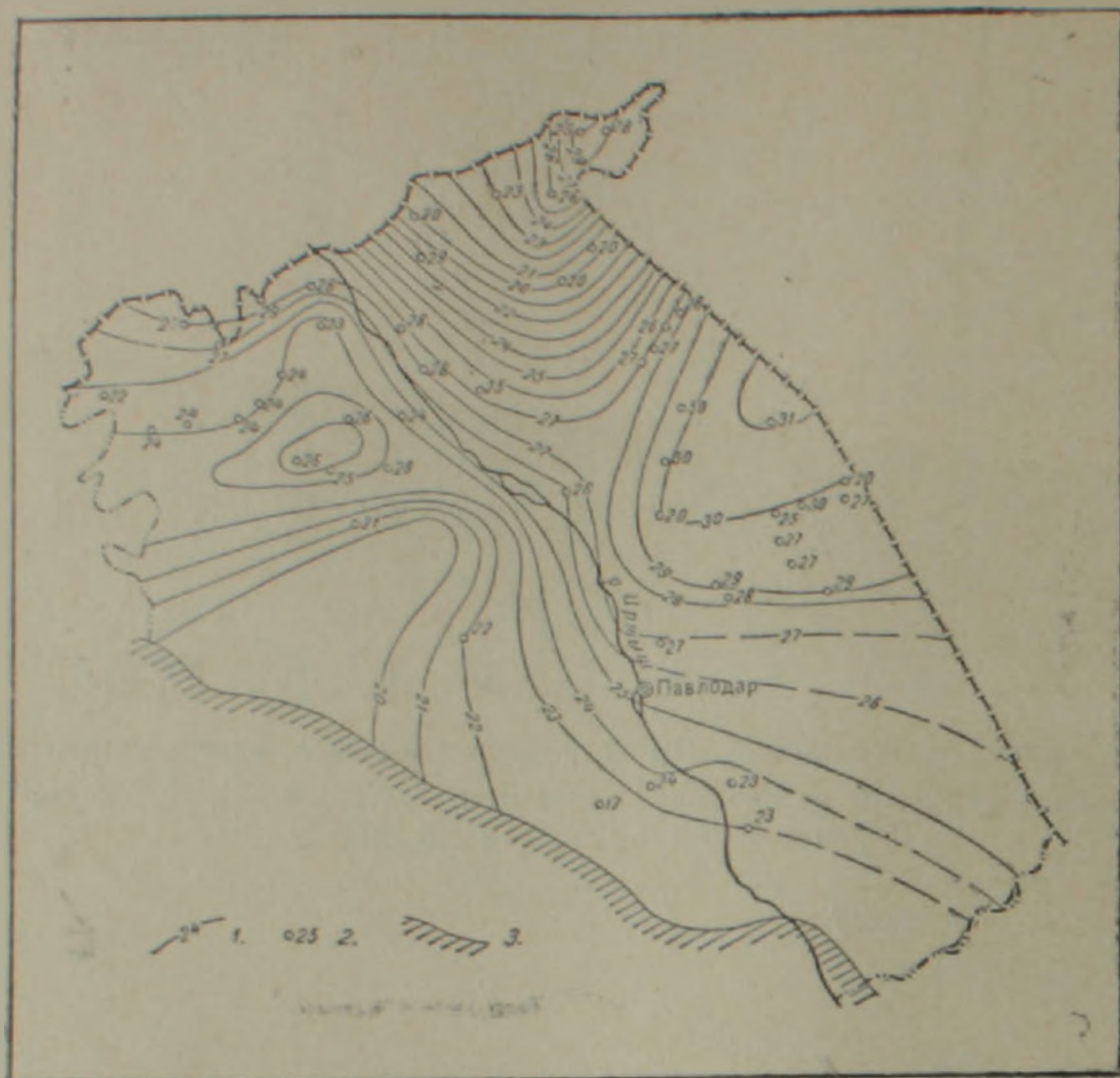
Фиг. 4. Схематическая карта пористости коньякско-сантонских отложений (Ипатовский водоносный горизонт): 1. Изолинии пористости. 2. Значение пористости по каротажу. 3. Граница меловых отложений.
