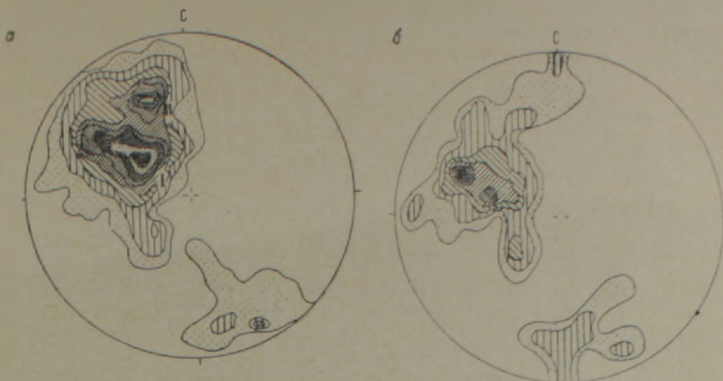
Фиг. 1. Диаграммы ориентировки пострудных трещин в породах вмещающих Агаракское месторождение. а—сводная диаграмма, 690 измерений, <1-2-3-4-5-6-7-8-9 и <\% . б—диаграмма ориентировки пострудных трещин в центральной части месторождения (горизонт 1135) 180 измерений, <1-2-4-6-8-10 и <\% .
