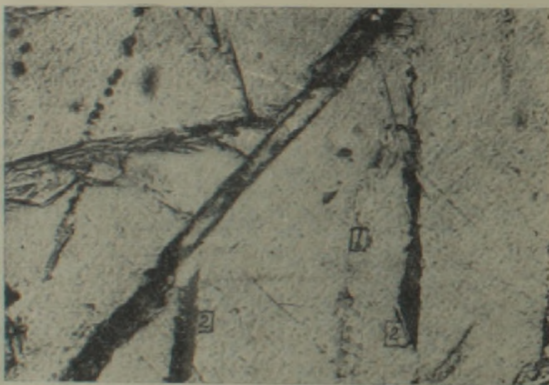
Фиг. 5. 1) залеченные галитом трещины по спайности, 2) включения битума. Скв. 8—Зейва, инт. 1100—1103 м. Прозрачный шлиф, увел. \times 55 , без анализатора
