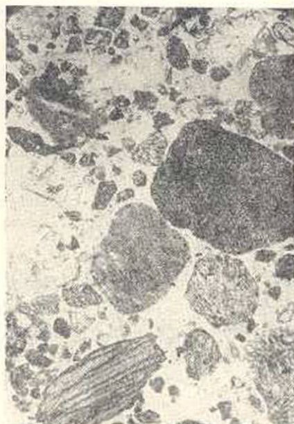
Фиг. 7. Природный туфовый песок Аванского м-ния, б/анализатора. Ув. 34.
