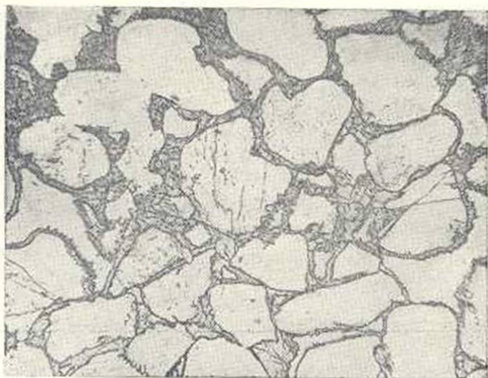
Фиг. 7. Микрофото шлифа кварцитовидного песчаника. Песчинки кварца сильно сцементированы халцедоновым цементом соприкосновения и выполнения. Увелич. 80. Николи +
