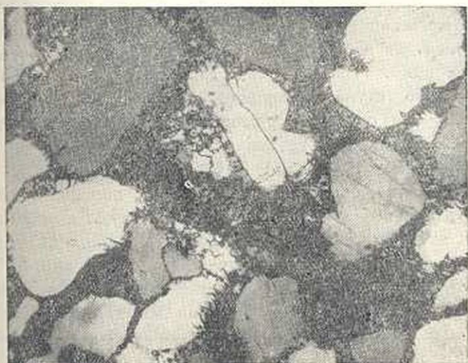
Фиг. 10. То же в скрещенных николях. Виден халцедоновый цемент в виде крустификации вокруг зерен кварца и заполнения пор между ними.
