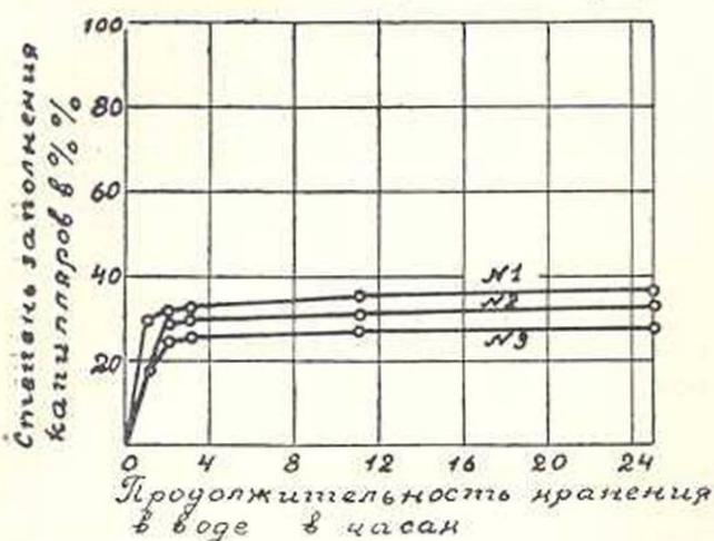
Фиг. 3. Влагоемкость литонидной пемзы в проц. от объема в зависимости от продолжит. хранения в воде.
