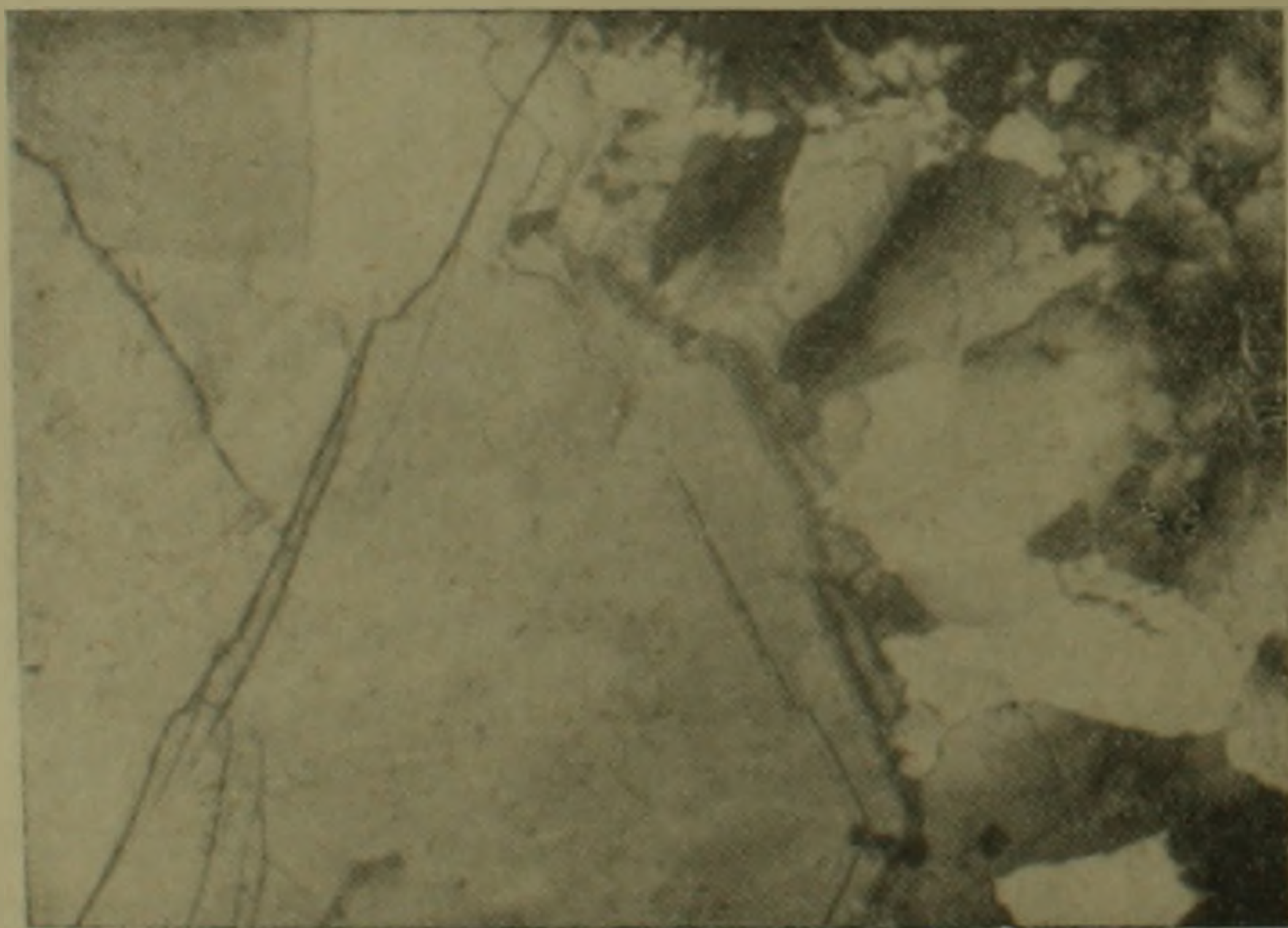
Фиг. 7. Укрупнение зерен кварца с одновременным очищением от механической примеси. Прозрачный шлиф. Ник. +. \times 30 .
