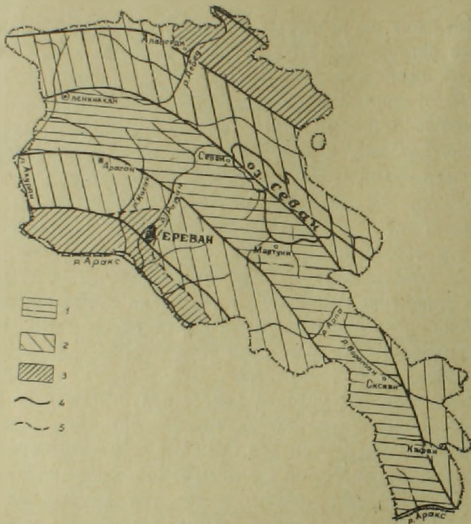
Фиг. 1. Прогнозная карта геотермического районирования Армянской ССР. 1 — район со средним геотермическим градиентом 5^\circ\text{C}/100\text{ м} и выше. 2 — районы со средним геотермическим градиентом 4^\circ\text{C}/100\text{ м} . 3 — районы со средним геотермическим градиентом 3^\circ\text{C}/100\text{ м} . 4 — границы тектонических зон (по А. Т. Асланяну). 5 — граница геотермического района, не совпадающая с границей тектонических зон.
