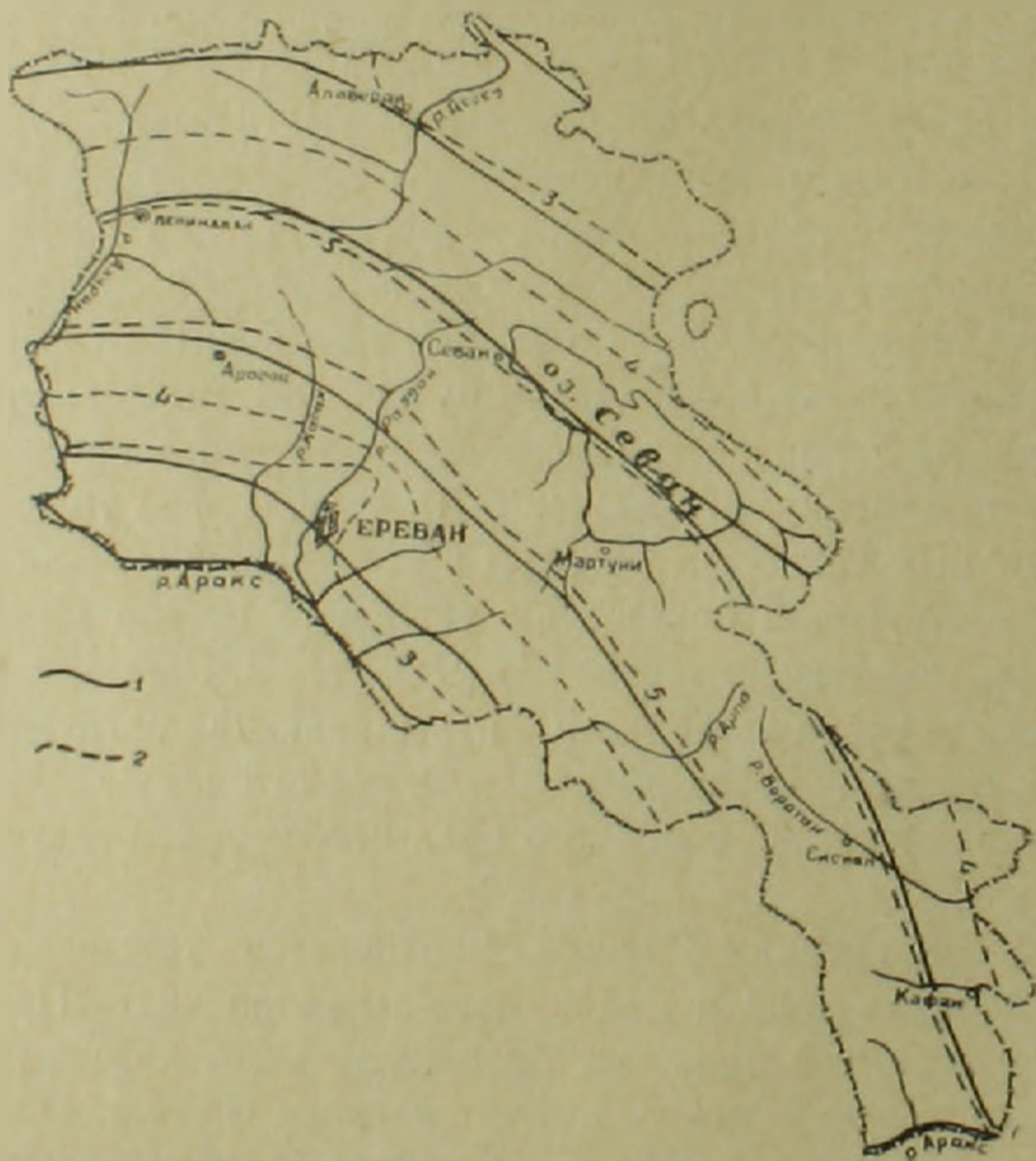
Фиг. 2. Схематическая карта предпологаемых равных геотермических градиентов. 1 — границы тектонических зон. 2 — изолинии предпологаемых равных геотермических градиентов ( ^{\circ}\text{C}/100 \text{ м} ).
