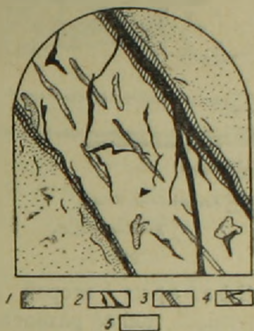
Фиг. 2. Взаимоотношение стадий минерализации. 1—пиритизация пород (1—стадия). 2—кварц-полиметаллическая стадия (с Au, Ag, Bi и Te ). 3—глина трения. 4—включения пиритизированных пород. 5—безрудный кварц.
