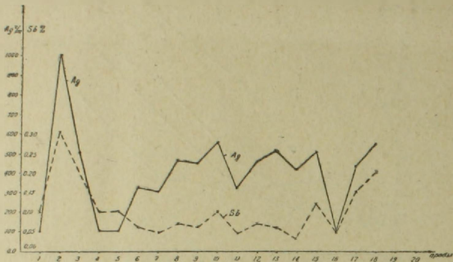
Фиг. 6. Зависимость содержания серебра от содержаний сурьмы в галенитах (№№ 1—5, по данным спектральных анализов) и свинцовых концентратах (№№ 6—18; Ag по данным пробирных, Sb — химических анализов).
