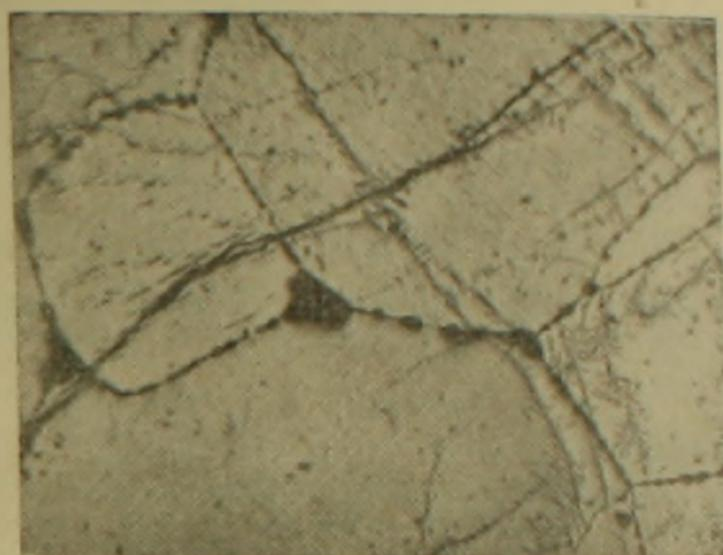
Фиг. 2. Пластинчатая и решетчатая структура титаномагнетита. Магнетит (серое) изометрические кристаллы, ильменит (светло-серое) тонкие пластинки в магнетите. Полированный шлиф.  $\times 150$ .
