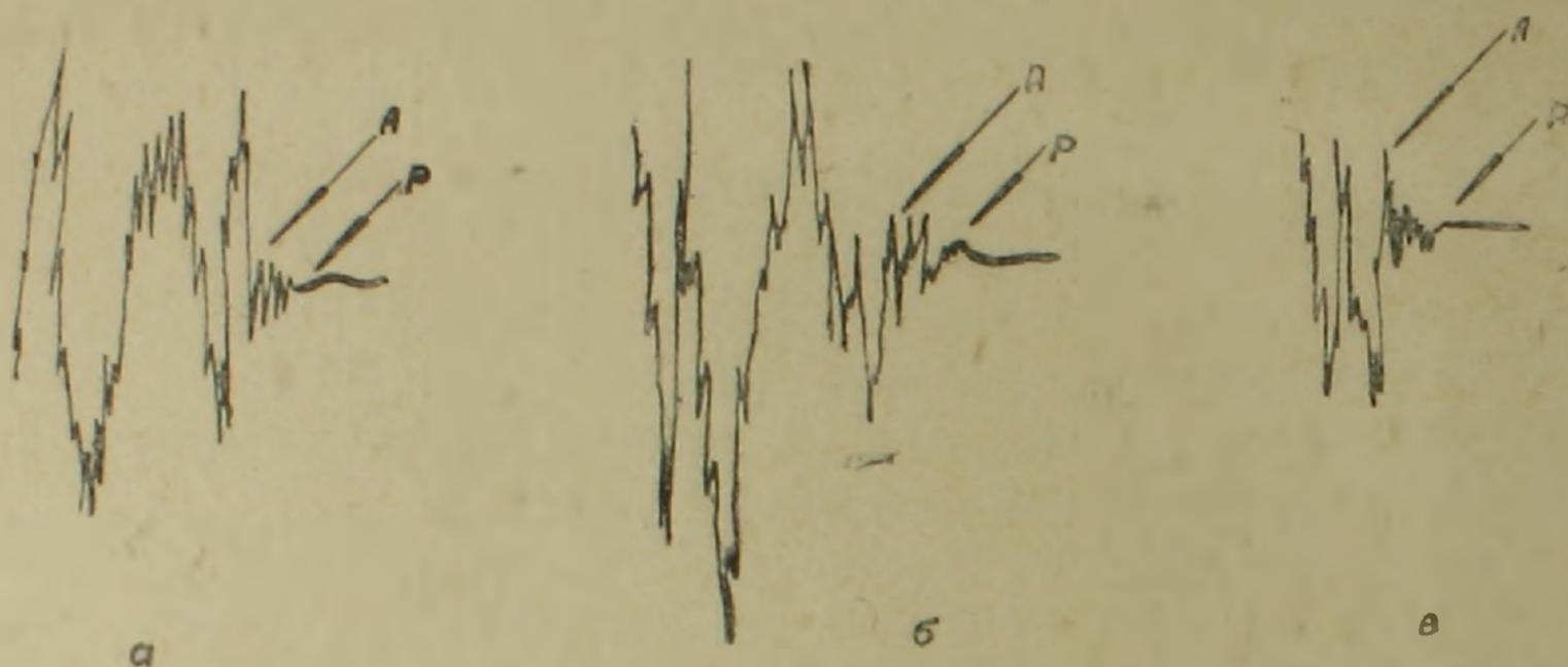
Фиг. 9. Сейсмическая станция „Горис“. Сейсмограммы землетрясения 1.II 1953 г. а—составляющая  $Z$ ; б—составляющая  $B-Z$ ; в—составляющая  $C-Y$ .
