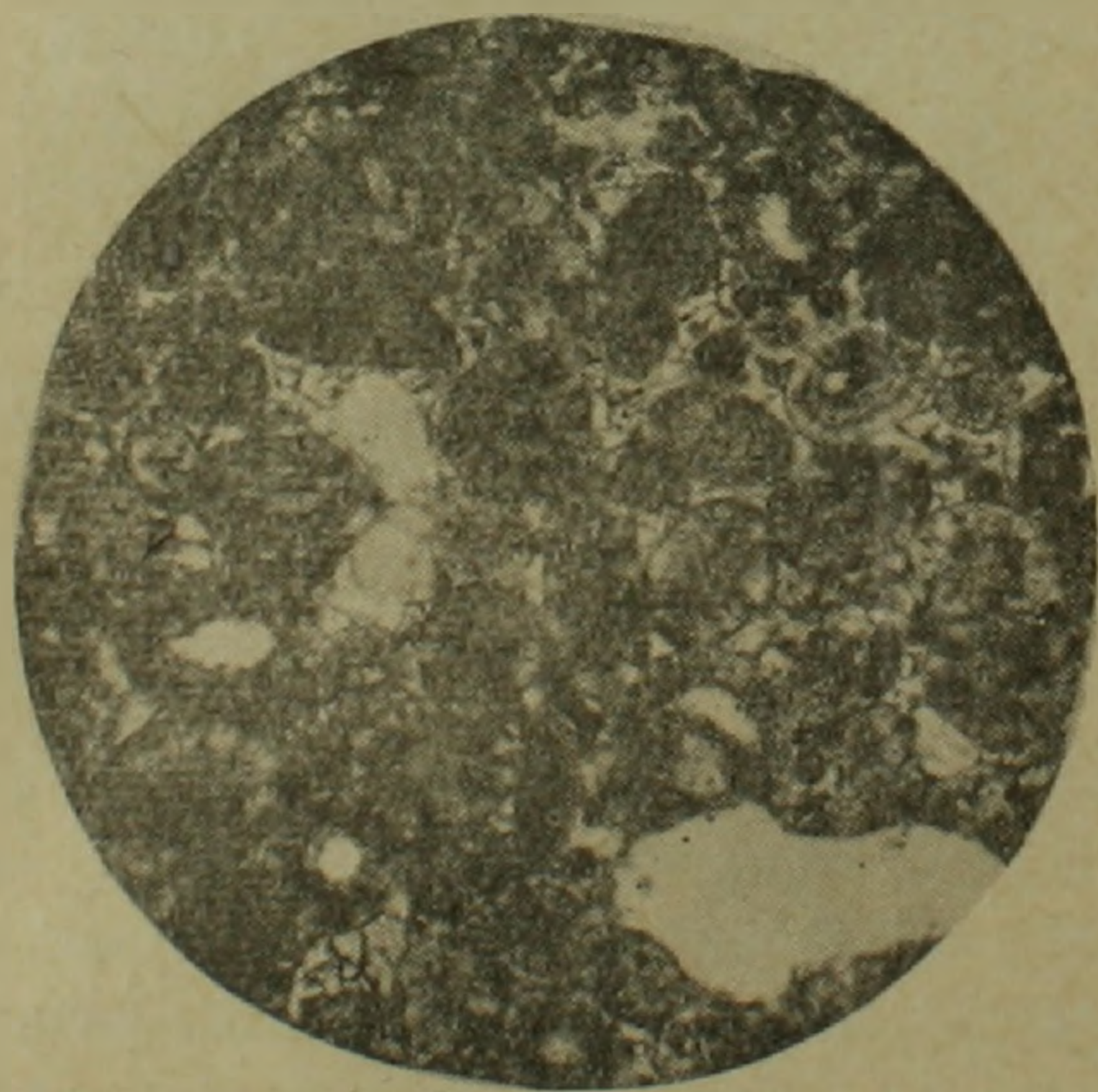
Фиг. 6. Оолитовый известняк. Радиально-лучистое и концентрически-скорлуповатое строение отдельных оолитов. Шлиф, \times 50 , николи +
