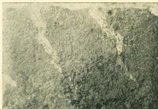
Фиг. 11с. Вертикальный разрез трещин на дне колеи колеса  $640 \times 160$  мм; глубина колеи 53 мм ( $K = 33$ ).
