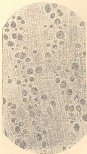
Рис. 4. Поперечный срез древесины нагорного дуба.
