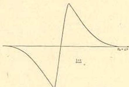
Фиг. 8. Спектр поглощения фторопласт — 4 при  $t = 25^\circ\text{C}$ .
