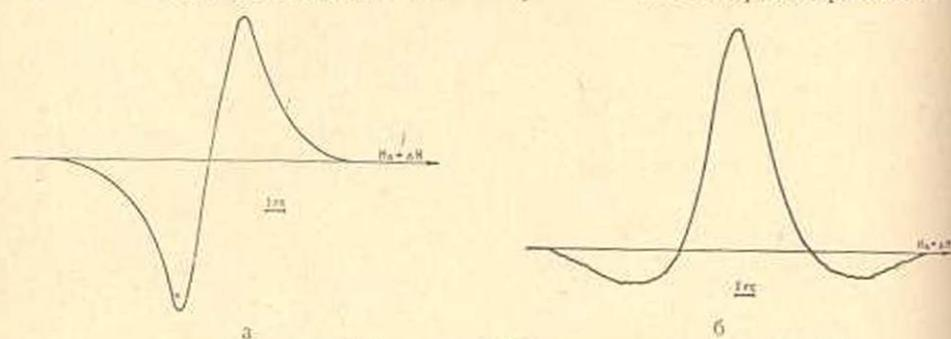
Фиг. 7. Спектр ПММА при  $t = 25^\circ\text{C}$  а/поглощение, б/дисперсия.
