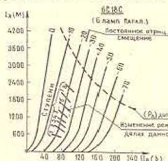
Фиг. 6. Режим работы проходных ламп системы стабилизации на различных ступенях (I_m)_{нач} .
