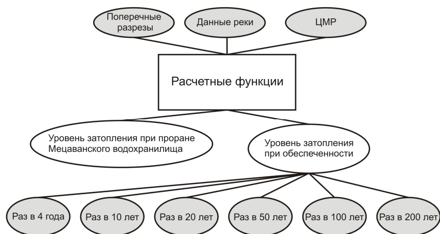
Рис. 6. Схема расчетной модели ГИС затопления территорий
