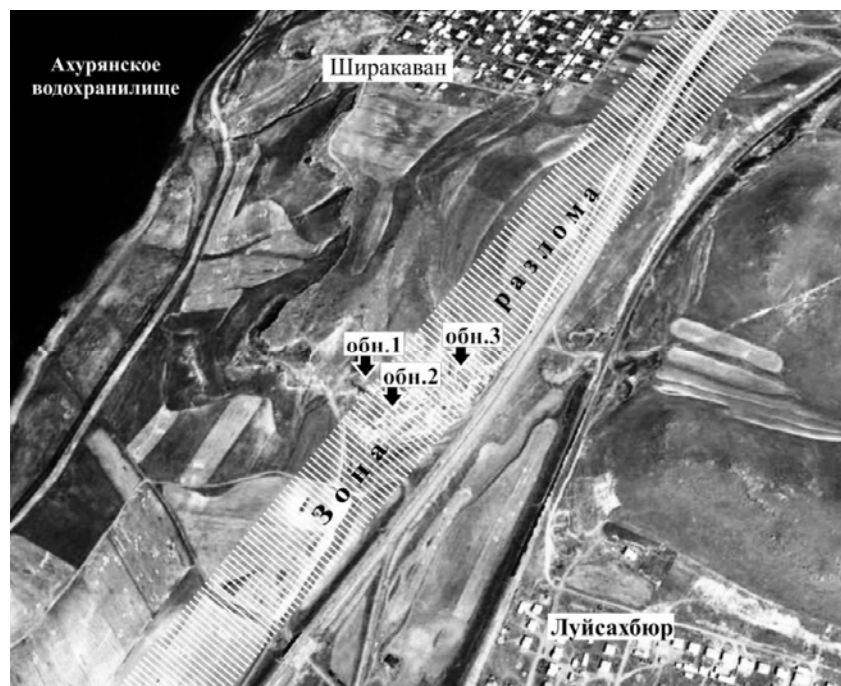
Рис.2. Обнажения 1, 2 и 3 в туфовом карьере в зоне Ахурянского разлома. (космический снимок высокого разрешения)
