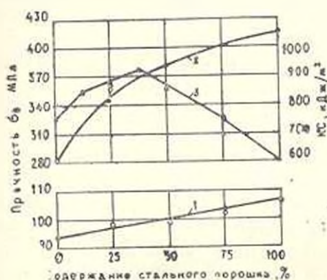
Рис. 1. Прочность на разрыв образцов, изготовленных из смеси стального и железного (ПЖ2М1) порошков: 1 — пористые (П-20%); 2, 3 — беспористые (П-0%).
