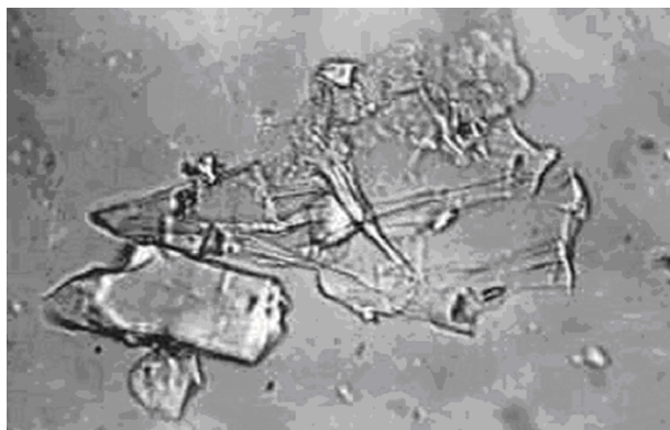
Рис. 3. Микрофотография агрегата кристаллов Na-четырекремнефтористой слюды. Увел. Ч900.
