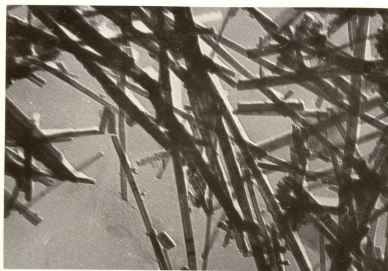
Рис. 4. Электронно-микроскопическая фотография синтезированного волокнистого фторсиликата, полученного из серпентинита (18000х).
