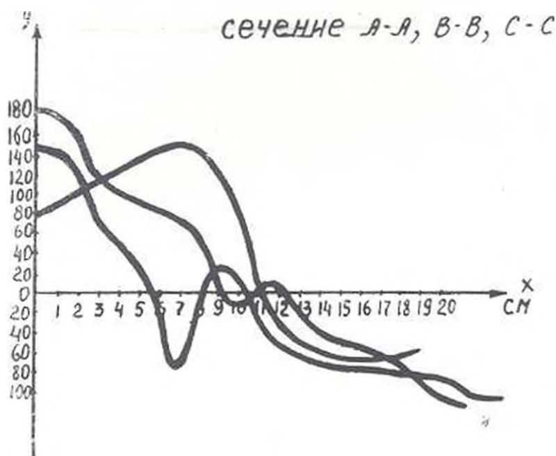
Рис. 4. Кривые распределения нормальных напряжений \sigma в сечениях. 1 — А-А; 2 — В-В; 3 — С-С.
