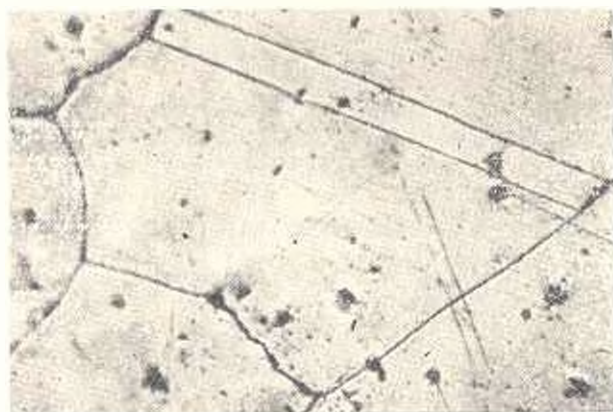
Рис. 1. Микроструктура исследуемой стали X18H10T в отожженном состоянии. \times 300 .
