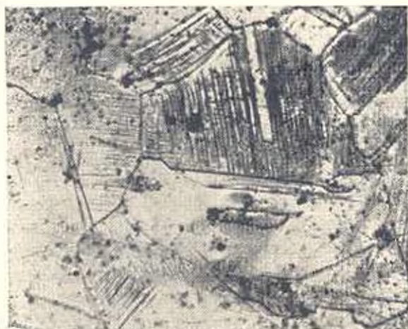
Рис. 3. Микроструктура стали X18H10T после циклической деформации при 20°C ( \sigma = \pm 235 МПа, N = 5000 цикл), \times 300 .
