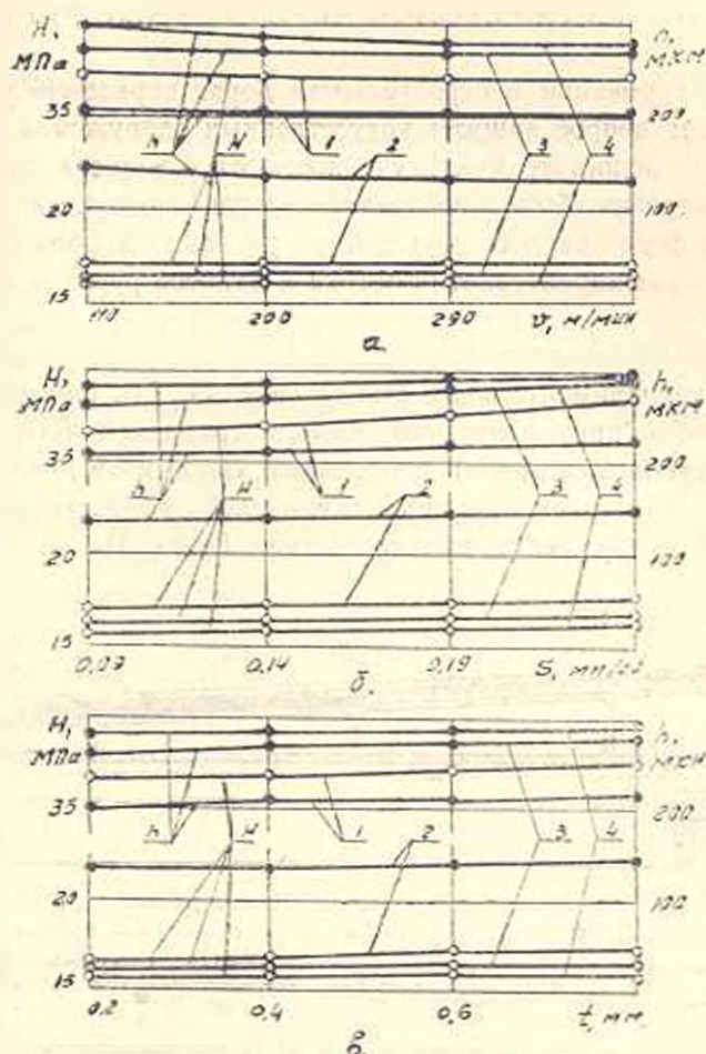
Рис. 1. Влияние режимов фрезерования v , s , f на величины микротвердости H и глубины наклепа h_f . 1 — сталь 45, 2 — бронза БрХЗ, 3 — латунь Л62, 4 — дюралюминий Д16.
