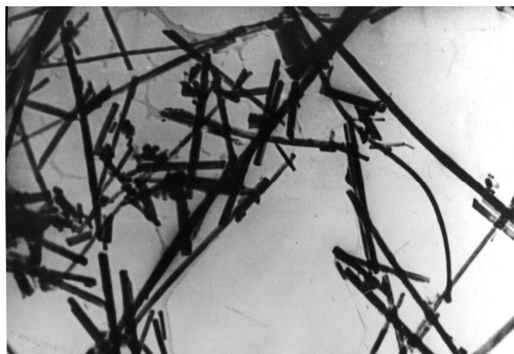
Рис. 3. Электронно-микроскопическая фотография синтетического волокнистого гидроксилфторамфибола, полученного из серпентинита (ув. 18000х).
