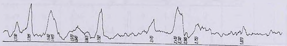
Рис.4. Дифрактограмма продукта, полученного нагреванием смеси СГМg-NaCl при t=750^\circ\text{C} , \tau=2 ч. Линии: а) энстатита d/n 3,40; 3,16; 2,88; 2,83; 2,54; 2,48; 1,51; 1,44 Å; б) NaCl d/n 2,88; 2,04; 1,65 Å.
