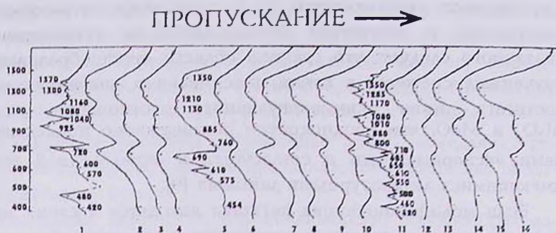
Рис.2. ИК спектры поглощения стекол и продуктов их кристаллизации в системах MeB_2O_4-Al_2O_3 (Me-Zn, Cd, Pb): 1 - ZnB_2O_4 закрис. стекло; 2 - ZnB_2O_4 стекло; 3 - 10, 4 - 20 мол % Al_2O_3 ; 5 - CdB_2O_4 закрис. стекло; 6 - CdB_2O_4 стекло; 7 - 10, 8 - 20, 9 - 30; 10 - 40 мол % Al_2O_3 ; 11 - PbB_2O_4 закрис. стекло; 12 - PbB_2O_4 стекло; 13 - 10, 14 - 20, 15 - 30, 16 - 40 мол.% Al_2O_3 .
