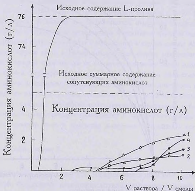
Рис.2. Динамика разделения L-пролина от сопутствующих аминокислот при разных носителях. 1) ЭДЭ-10п; 2) АВ-17; 3) АВ-17-8; 4) АВ-17-2п.
