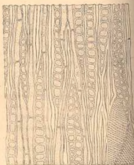
Рис. 6. Тангентальный срез древесины Carpinus cordata Bl. Ув. 280.
