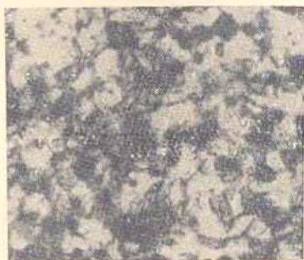
Рис. Структура спеченного электродного материала а — W + 5\% Y_2O_3 \times 500 ; б — W + 5\% Y_2O_3 + 5\% TiC \times 2000 .
