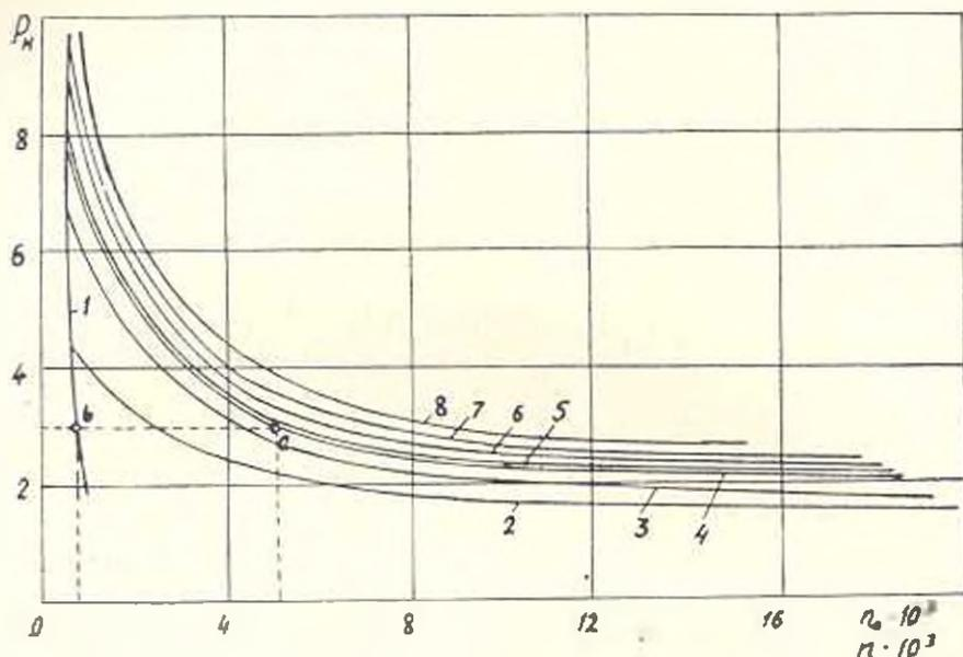
Рис. 2. Зависимость  $n_0$ ,  $\text{м}^3/\text{кг}$  от  $P_n$ ,  $\text{атм}$  (кривая 1) и  $P_n$  от  $n$ ,  $\text{м}^3/\text{кг}$  (кривые 2—8). Кривая 2 —  $G = 2 \text{ кг/с}$ ;  $D = 52 \text{ мм}$ ;  $L_T = 50 \text{ м}$ ; 3 — 2, 78, 100; 4 — 2, 52, 100; 5 — 3, 52, 100; 6 — 4, 52, 100; 7 — 2, 38, 100; 8 — 2, 52, 150. Во всех случаях  $L_R = 3 \text{ м}$ .
