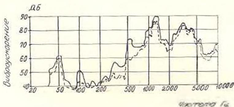
Рис. 1. Спектры уровней виброускорения ЭМ типа 4AA50A2.
