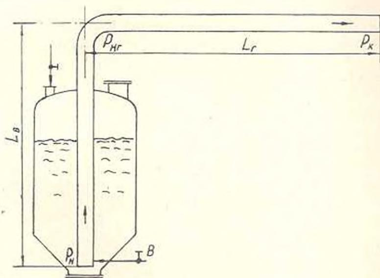
Рис. 1. Установка пневмотранспорта.
