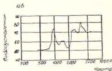
Рис. 2. Амплитудно-частотная характеристика ЭМ типа 4AA50A2.
