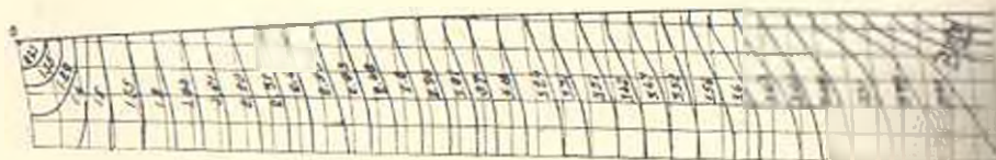
Рис. 3. Линии одинакового потенциала (давления) при работе горизонтального дренажа.
