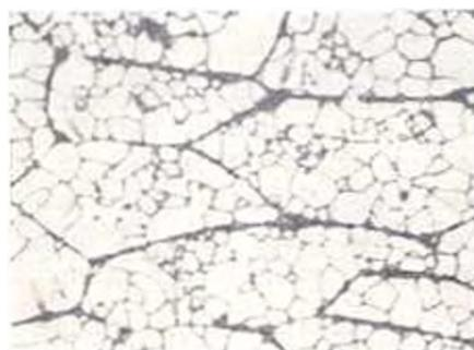
Рис. 2 Самодиффузия  $^{63}\text{Ni}$  в сплаве Ni+0,1% В (холодная деформация 30%, диффузионный отжиг 600°C, 1 час). Авторадиограмма  $\times 20$
