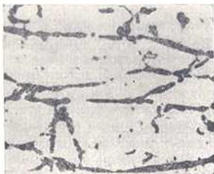
Рис. 4. Самодиффузия  $^{63}\text{Ni}$  в сплаве Ni+0,1% В (холодная деформация 40%, диффузионный отжиг 300°С—6 часов). Автораддиограмма.  $\times 25$
