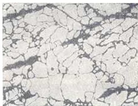
Рис. 6. Самодиффузия ^{63}\text{Ni} в сплаве \text{Ni}-0,1\% \text{B} (холодная деформация 10%, предварительный отжиг 800^\circ —4 часа, диффузионный отжиг 800^\circ —1 часа, диффузионный отжиг 800^\circ —3 часа). Фотография автораднограмм, \times 50
