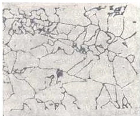
Рис. 1. Самодиффузия ^{63}\text{Al} в сплав \text{Ni}-10\%\text{Co} (холодная деформация 40%, предварительный отжиг при 700^{\circ}\text{C} —7 часов; диффузионный отжиг 700^{\circ}\text{C} —3 часа). Контактная автораддиограмма, \times 50 .
