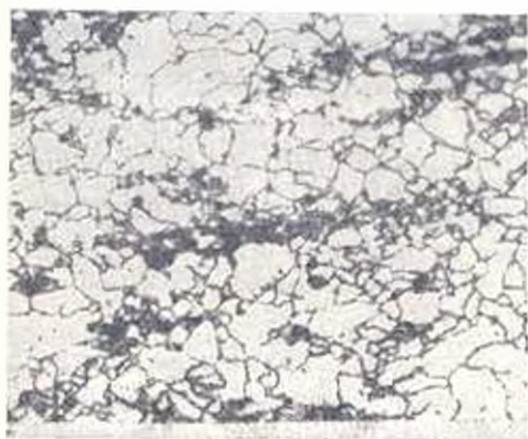
Рис. 5. Самодиффузия ^{63}\text{Ni} в сплаве \text{Ni}-0,02\% \text{Ce} (холодная деформация 40%, предварительный отжиг 700^\circ\text{C}-7 часов, диффузионный отжиг 700^\circ\text{C}-3 часа). Контактная автораднограмма, \times 50
