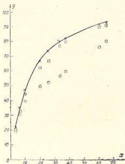
Рис. 1. Экспериментальные и расчетные данные системы ацетальдегид-винилацетат: X, O, □ — расчетные данные по моделям Редлиха-Кистера, Маргулеса, Ван-Лаара
