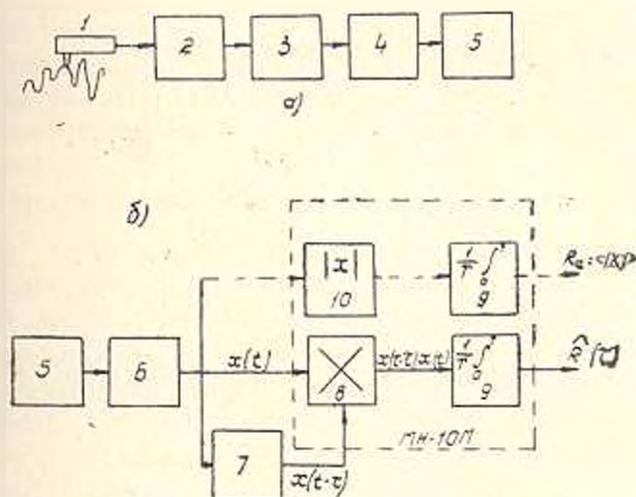
Рис. 5. Блок-схема коррелятора: а—измерение и запоминание; б—воспроизведение и расчет; 1—датчик; 2—профилометр; 3—ограничивающий фильтр; 4—модулятор; 5—магнитофон; 6—демодулятор; 7—блок постоянного запаздывания; 8—блок перемножения; 9—блок усреднения; 10—блок выделения модуля.
