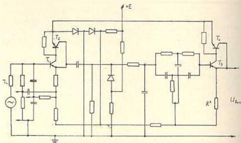
Рис. 7. Схема активного фильтра, согласованного с сигналом-откликом
