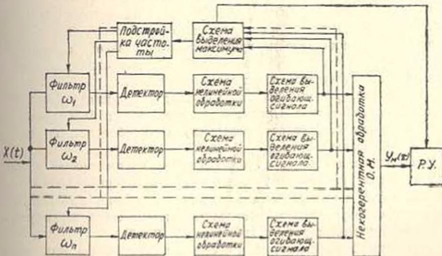
Рис. 6. Блок-схема приемника обнаружения
