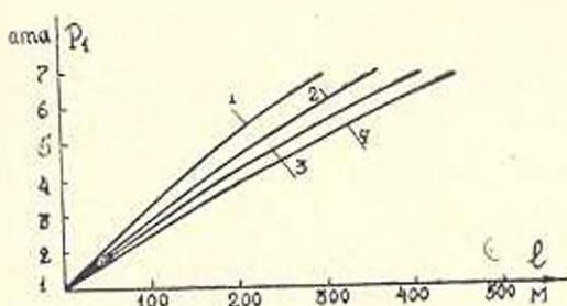
Рис. 3. Зависимость длины перемещения от давления при ступенчатом трубопроводе. (Номера кривых, начальные диаметры и производительности соответствуют приведенным на рис. 1).
