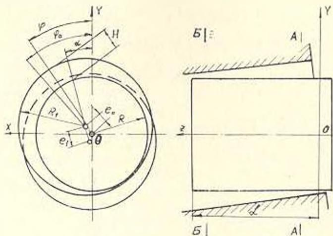
Рис. 1. Схема плунжерной пары
