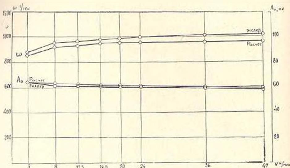
Рис. 2. Изменение частоты и амплитуды колебания при изменении скорости перемещения хобота
