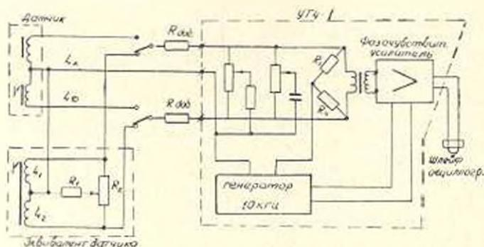
Рис. 3. Схема включения индуктивных датчиков
