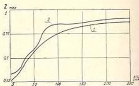
Рис. 5. Расчетная и экспериментальная зависимости максимального значения относительных эксцентриситетов от времени
