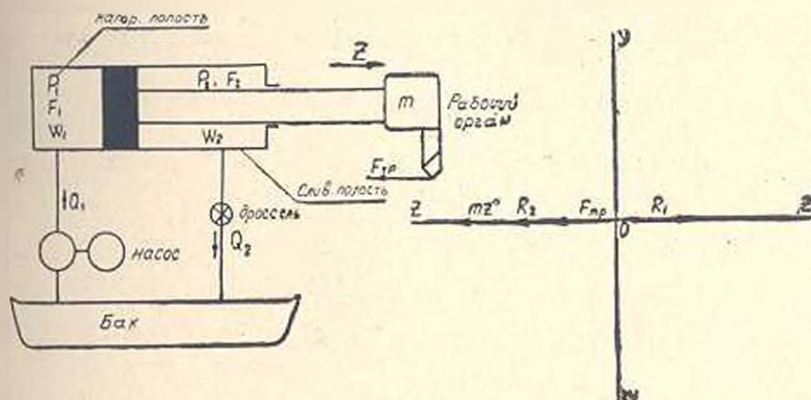
Рис. 1. Схема расположения сил при движении рабочего органа (хобота) станка.
