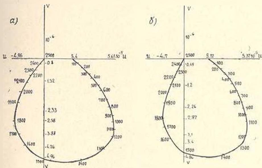
Рис. 3. Амплитудно-фазово-частотная характеристика системы при скоростях перемещения хобота: а—13 м/сек; б—60 м/сек
