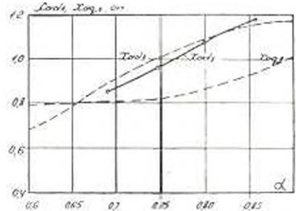
Рис. 3. Зависимость сопротивлений  $x_{ad3}$  и  $x_{aq3}$  от  $\alpha$  для генератора ECC82-4:
