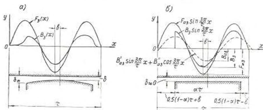
Рис. 1. Реакции ДО при реальном (а) и идеализированном (б) роторах.
