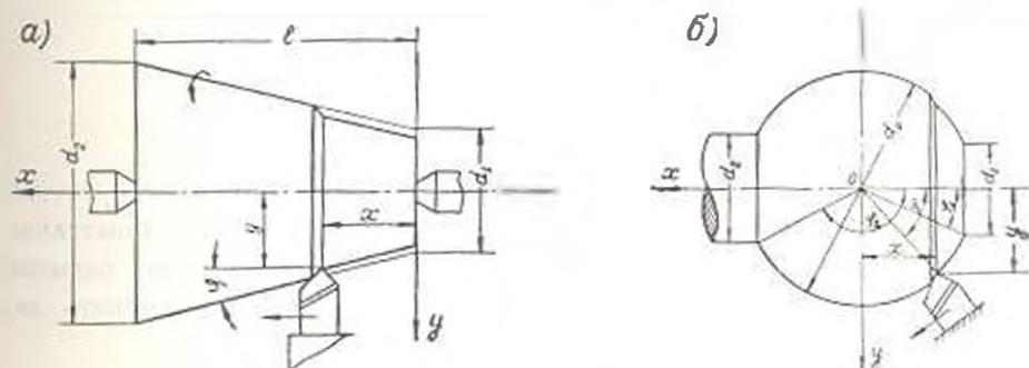
Рис. 1. К определению эквивалентного диаметра: а — конической поверхности; б — сферической поверхности.
