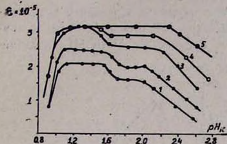
Рис. 1. Зависимости значений \epsilon в ацетоновых растворах соединения МНК-МГ от \text{pH}_\kappa , полученные при различной выдержке растворов МНК. C_{\text{Nb(V)}} = 1 \cdot 10^{-5} М, C_{\text{MoO}_4^{2-}} = 2,95 \cdot 10^{-3} М, C_{\text{МГ}} = 3,72 \cdot 10^{-4} М, \text{pH}_\kappa 0,5, время выдержки МНК, мин; 1—3, 2—6, 3—12, 4—20, 5—25÷90.
