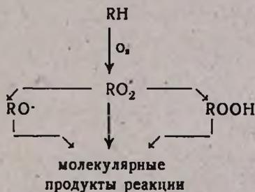
Механизм цепного процесса, направление элементарных стадий, приводящих к образованию различных продуктов реакции, зависят от состава сырья, эффективных констант скорости образования промежуточных продуктов, времени пребывания сырья в реакционной зоне. При изменении этих параметров возможно управление процессом с преобладающим выходом целевого кислородсодержащего соединения.
