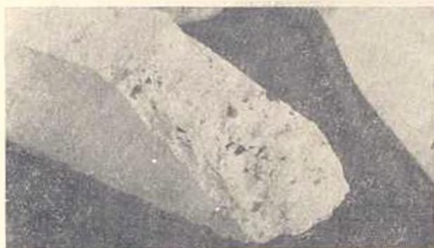
Рис. 2. Характер разрушения бетонных балок при кручении.
