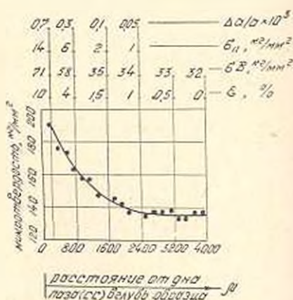
Рис. 3. Характер изменения свойств малоуглеродистой стали, обусловленного внедрением клиновидного индентора, с углом при вершине 2\alpha = 100^\circ .
