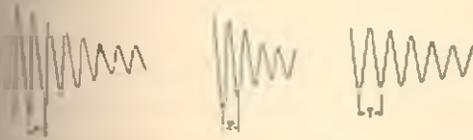
Рис. 3. Запись колебания бруса цилиндрического сечения из вальцмассы.
