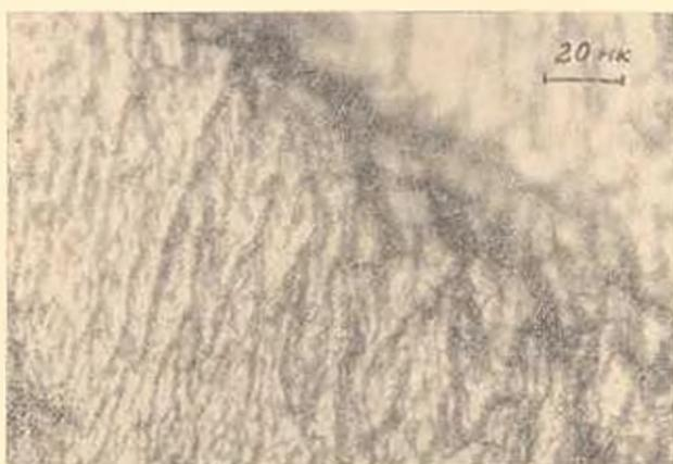
Рис. 1. Бороздки на поверхности излома образца с V-образным надрезом. Строение излома у грани зерен
