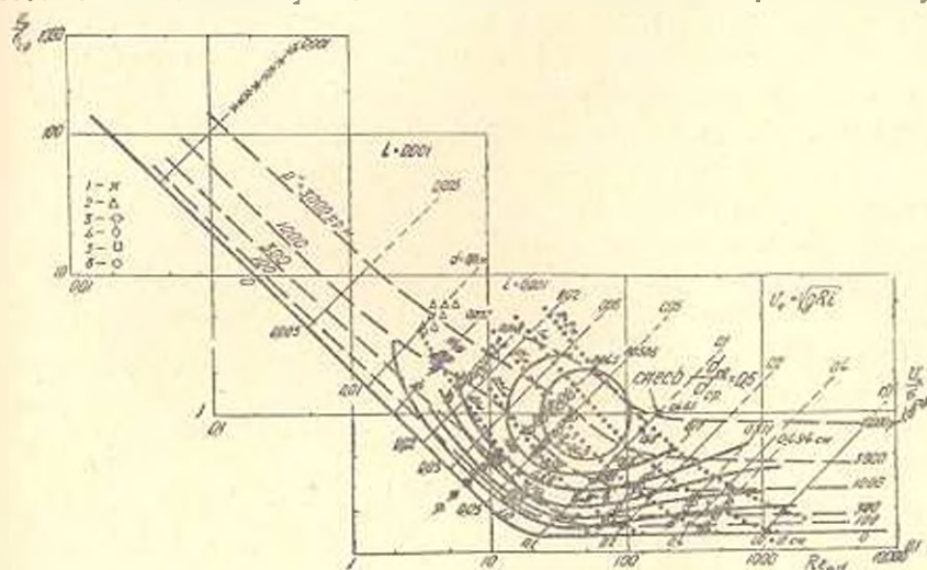
Рис. 3. 1—опыты Калинского и Хена d=0,0011 см; 2—Лаурсена—0,01 см; 3—Брукса—0,0137 см; 4—Бартон и Линн—0,018 см; 5—Симонс и Ричардсон—0,045 см; Джилберт—0,0506, 0,17, 0,317, 0,491 см. Залитые точки рифели и гряды. Незалитые—безгрядовое русло и песчаные волны. Сплошные линии—линии равных \frac{R'}{R} ; пунктирные линии—линии равных концентрация наносов помноженные на 10^3 ; точечные линии—линии равных R .
