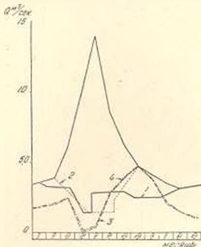
Рис. 4. Совмещенные графики подземного стока, построенные различными методами. 1—по способу анюра; 2—по Н. Н. Веригину; 3—по А. Т. Иванову с поправкой; 4—то же без поправки.
