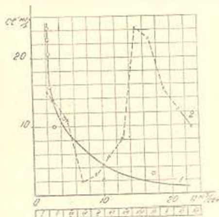
Рис. 1. Кривые изменения хлорного числа по месяцам (кривая 2) и его зависимости от среднемесячных расходов воды р. Касах у с. Аштарак за 1955 г. (кривая 1)
