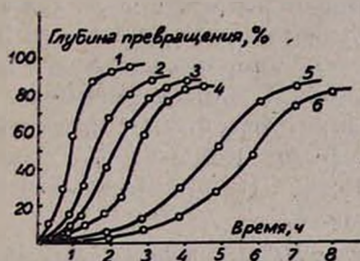
Рис. Кинетические кривые зависимости глубины превращения от продолжительности полимеризации; 1 — VIa, 2 — VIб, 3 — Va, 4 — Vб, 5 — VIв, 6 — Vв.
