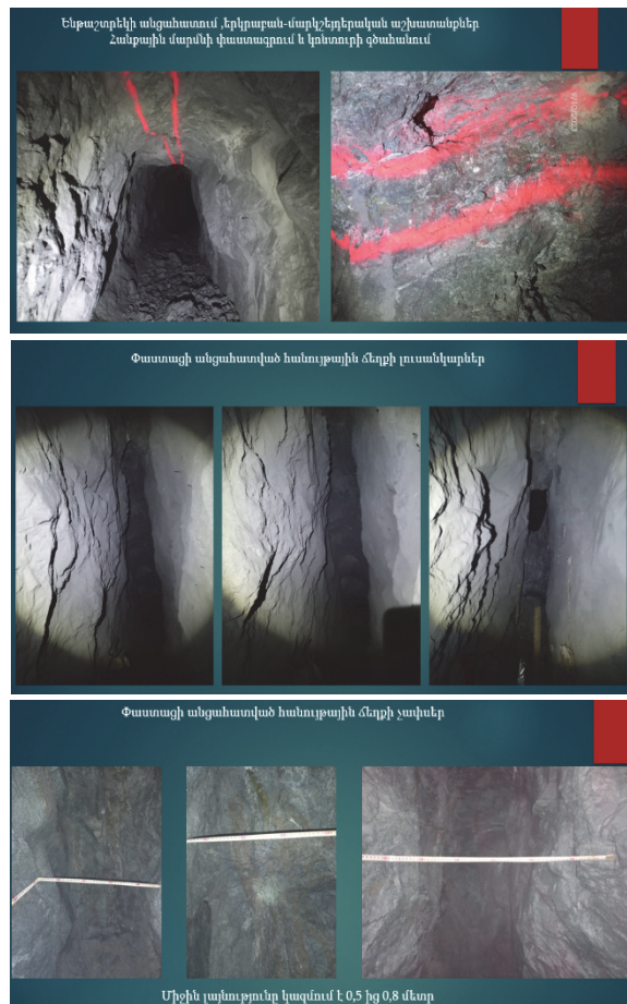
Նկ. 8. Ենթահարկային շտրեկներով՝ հանքաքարի ճեղքային հանությամբ մշակման համակարգի առաջարկվող տարբերակի դեպքում հանության ճեղքի պատկերը
