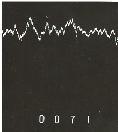
Նկ. 2. ПС-Н18К10М5Re մակնիշի փոշեպողպատում Mo-ի բաշխվածության սկանագիրը. T_{\text{եր}} = 1100^\circ\text{C} , \tau_{\text{եր}} = 2\text{ ժ}
