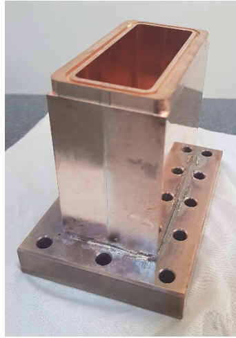
Նկ. 5. Երկար ալիքատարի և կցաշուրթի զողման առաջին (ա) և երկրորդ (բ) նմուշները
