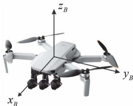
Рис. 4. Оси координат, связанные с БПЛА
