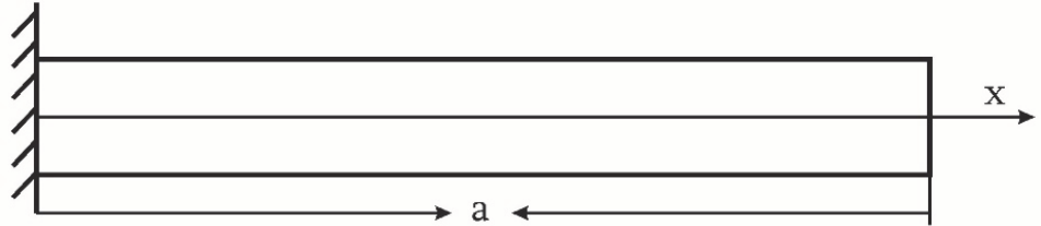
Рис. 2. Биморфная пьезоэлектрическая пластина с жестко заземленным левым краем
