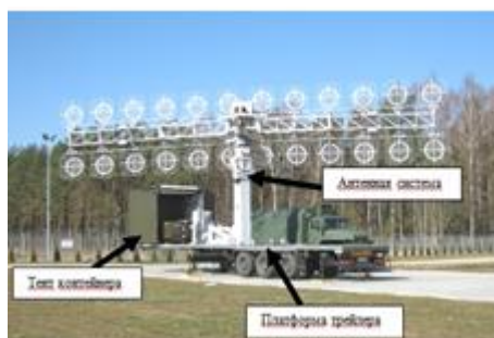
Рис. 1. Фотоснимок смонтированной на платформе антенной системы
