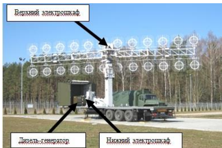
Рис. 7. Основные единицы подсистемы энергоснабжения и автоматического управления
