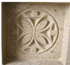
Рис. 3. Сложнопрофильные изделия, изготовленные на станке с ЧПУ
