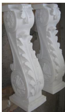
Рис. 3. Сложнопрофильные изделия, изготовленные на станке с ЧПУ
