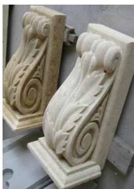
Рис. 3. Сложнопрофильные изделия, изготовленные на станке с ЧПУ
